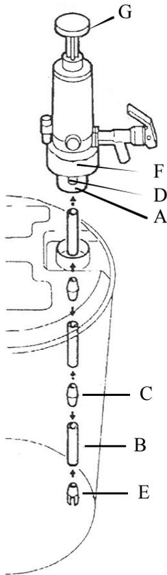
**Das Material der Handpumpe besteht aus Polypropylen und NBR-Dichtungen.**
